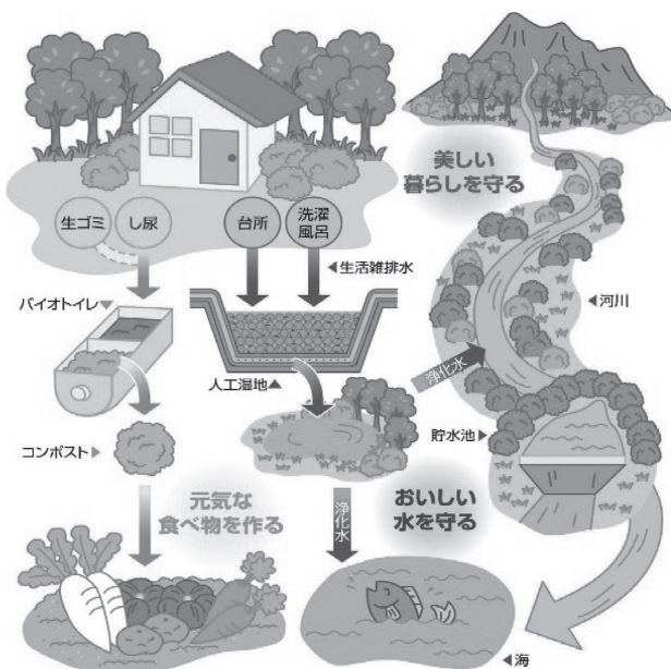
図1 分離分散型排水処理システムの概念図
